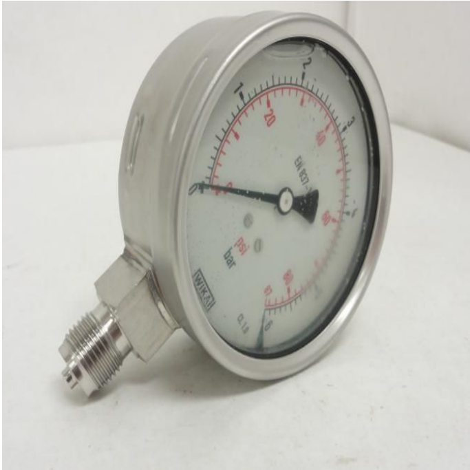
Манометър WPKA 0..2,5bar - Ф100 - G1/2 - клас на точност 1
